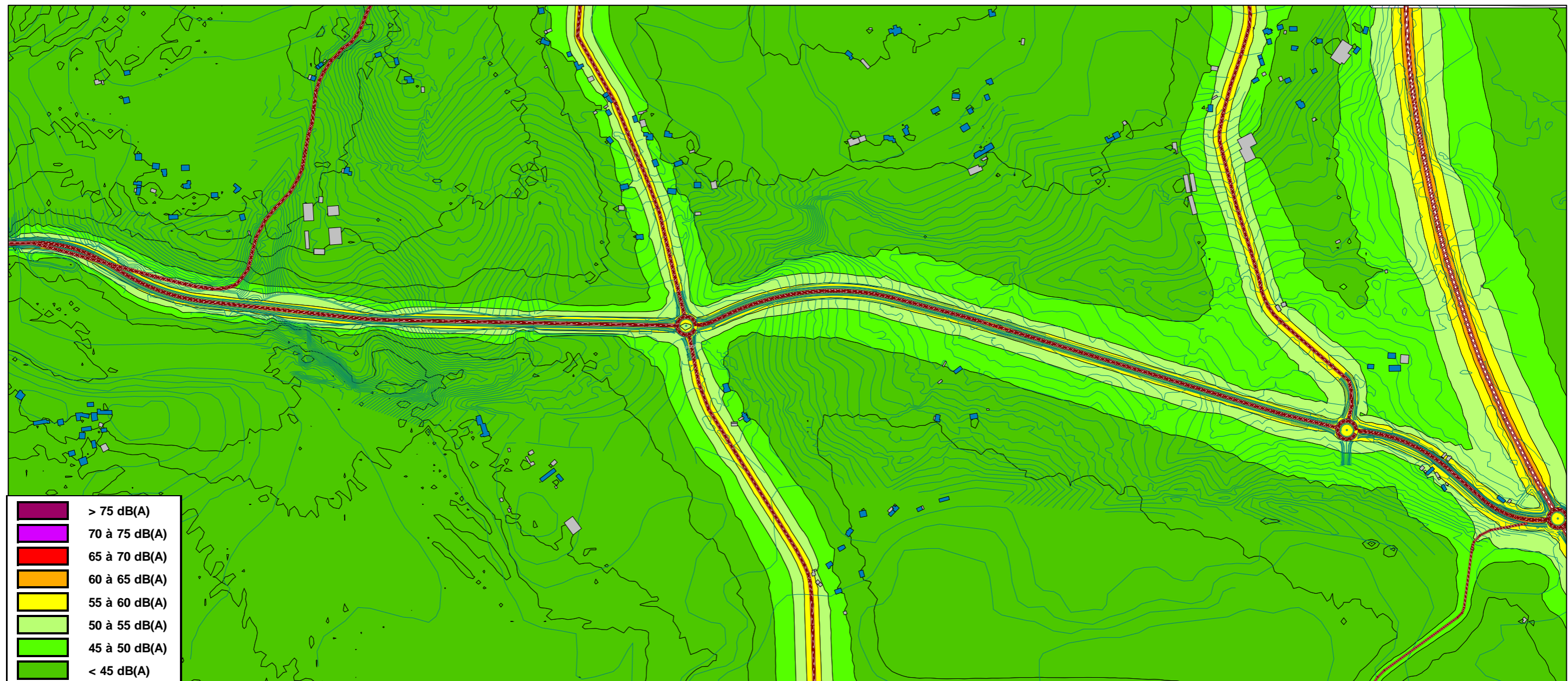
Carte 22 : Carte de bruit à 4 mètres de hauteur en situation projet à long terme pour l'indicateur LAeq(22h-6h)
