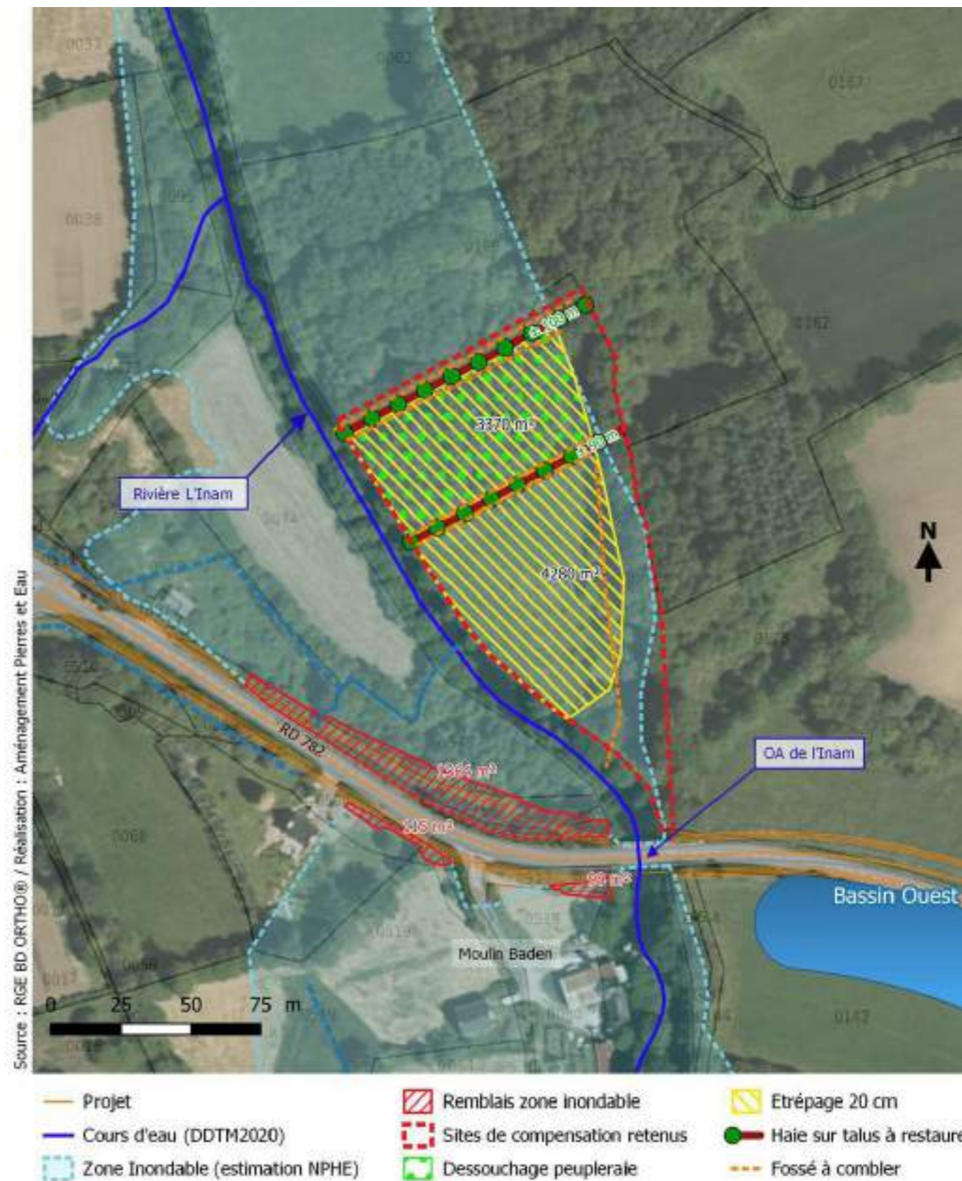
Carte 25 : Travaux de restauration du champ d'expansion des crues de l'Inam
