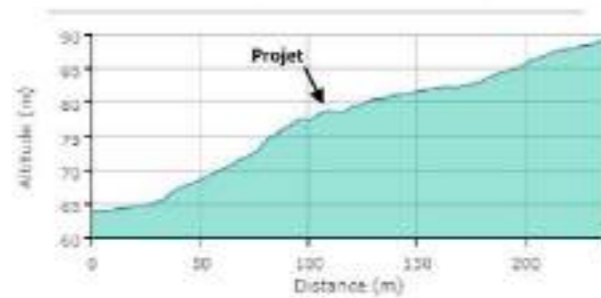
Profil altimétrique du ruisseau de Kerly de 100 m en amont du projet jusqu'à l'Inam
